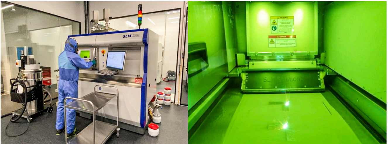
Figure 13 Imprimante industrielle pour l'impression 3D de titane. Procédé de fusion sur lit de poudre par faisceau laser ; taille du plateau d'impression : 280 × 280 × 350 mm.
